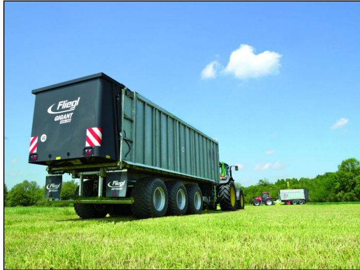
Slika 3. Prikolica za transport krutog stajskog gnoja
