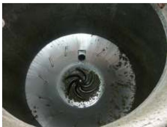
Slika 4. Unutrašnjost pulpera sa propelerom
