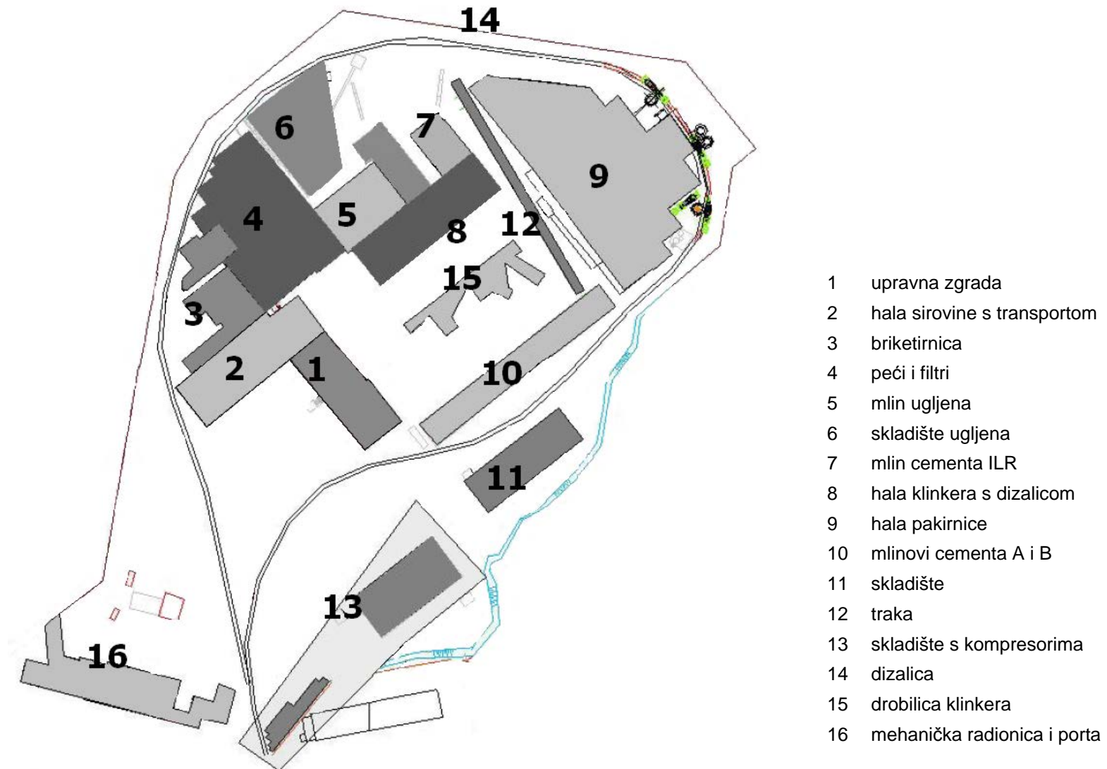
Slika 3 - Prikaz postrojenja prema posebnim tehnološkim dijelovima
