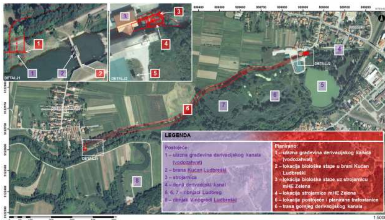
Slika 2 Kartografski prikaz situacije s označenim osnovnim objektima postojeće i planirane hidroelektrane na orto – foto podlozi
